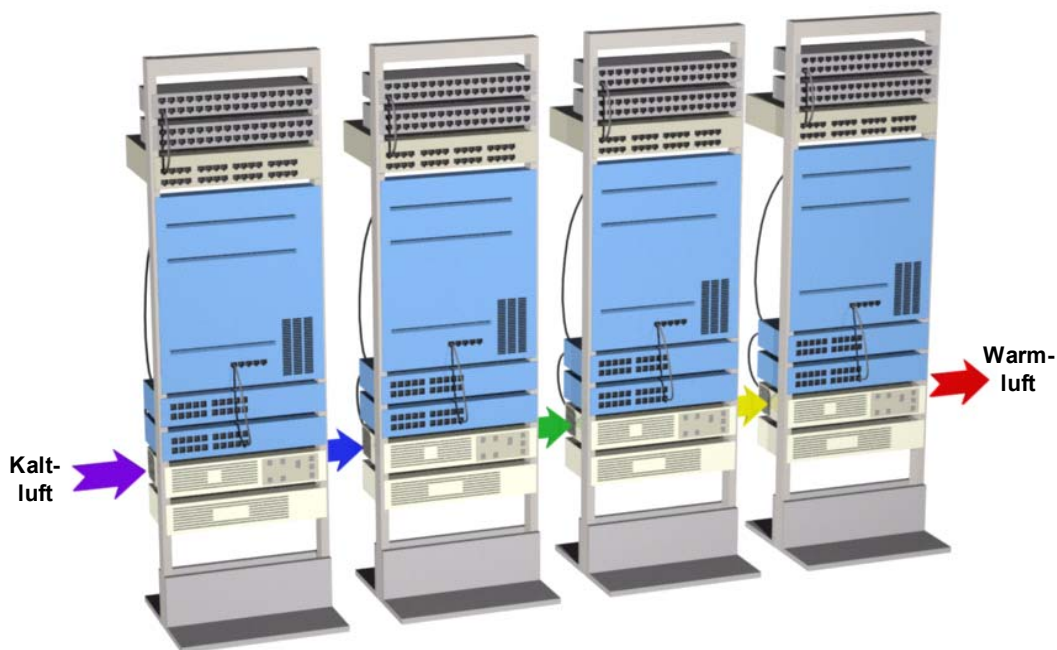
Abbildung 5 – Geräte mit seitlicher Luftstromführung in offenen Racks
