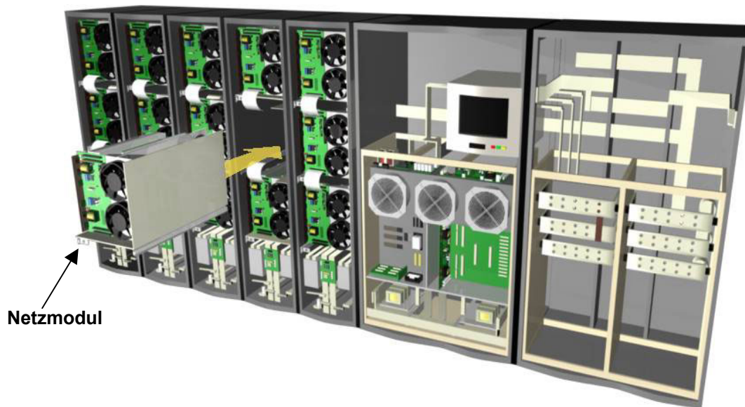
Abbildung 11 – Modulares, skalierbares USV-System
