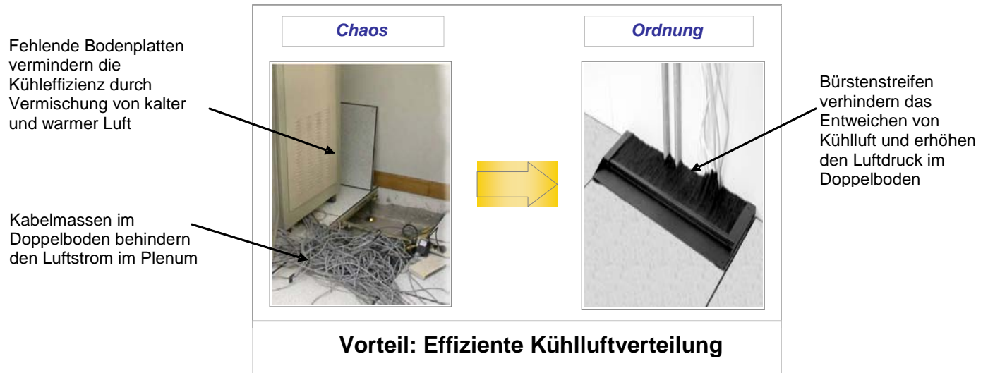
Abbildung 7 – Versiegelung von Öffnungen im Doppelboden
